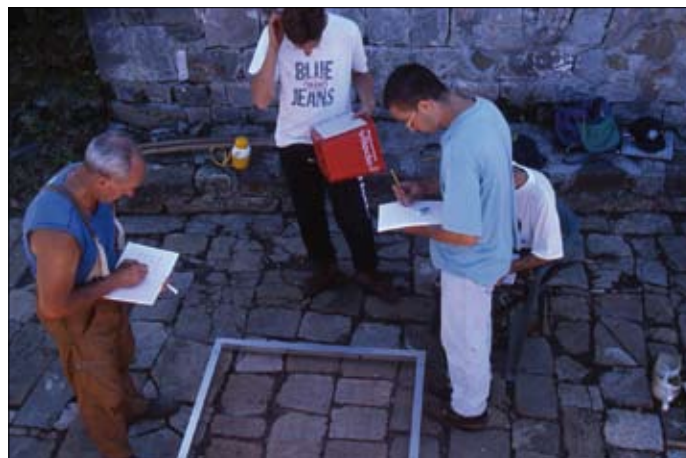
Fig. 4. Rilievo del lastricato presso il mastio (foto M. Lavarone).
