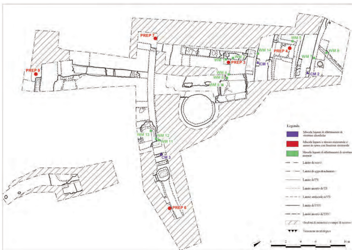
Fig. 109. Distribuzione spaziale dei campioni di miscela leganti prelevati dall'anfiteatro di Aquileia. Nell'immagine sono riportati esclusivamente i campioni prelevati da strutture in situ (rielaborazione grafica di Simone Dilaria su planimetria di Valeria Grazioli).
