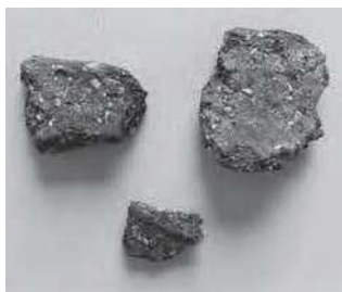
FIG. 11 | Frammenti di ceramica grezza con difetti di cottura
