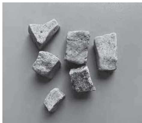
FIG. 5 | Mattonelle pavimentali di forma pressoché cubica ritagliate da tegole
